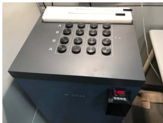
Messung im Wärmeflusskalorimeter über 7 Tage bei 40 °C
