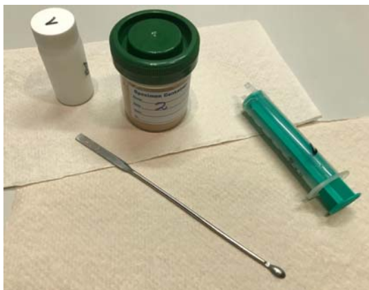
Materialien werden vortemperiert auf 40 °C, angerührt und in Messampulle überführt
